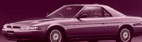
1990年4月登場のユーノスコスモは、3ローター20B-R E W型と2ローター13B-R E W型を搭載。シーケンシャルツインターボを採用し、滑らかで迫力のある加速をもたらした。20B-R E Wは280PSを発揮。3ナンバー専用ボディは、国産2ドア車最長のホイールベースとワイドトレッドを備えていた。キャビンは贅沢な2+2。インテリアに使用した革や木は、素材から吟味されていた。エンジン、サスペンション、ATミッションはもちろん空調システムまで電子制御したスーパーラグジュアリースペシャルティカー。
