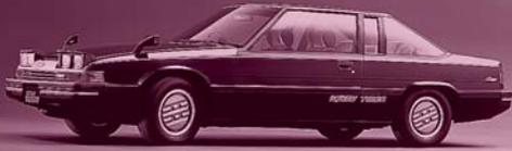
1981年10月にデビューした3代目コスモは、時代のニーズに対応するべく、高級スペシャリティカーとして開発された。スラントノーズにリトラクタブルヘッドライトを採用したボディは2ドアハードトップ、4ドアハードトップ、サルーンの3タイプが用意されていた。エンジンはデビュー当初6P1の12A型であったが、後に電子制御燃料噴射装置付きスーパーインジェクション方式13B型、12A型インバクタターボを追加した。サスペンションは4輪独立懸架に加えて電子制御サスペンションAASも装備し、速く快適な走行性能とした。
