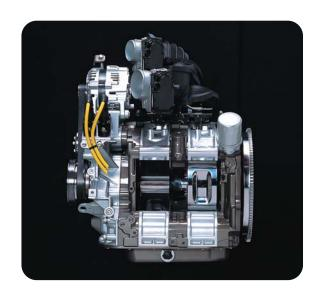
RENESISは、マツダの新しい4ドアスポーツカー マツダ RX-8 (参考出品車) に搭載される自然吸気ロータリーエンジンです。「新たなるREの始まり=Genesis」を意味する名を持ったこのロータリーエンジンは、1995年東京モーターショーで発表されたコンセプトスポーツカー RX-01に搭載されていたMSP-REを進化させたものであり、1999年の同モーターショーに出品したRX-EVOLVに初めて搭載しました。今回、RX-8への搭載にあたってさらに熟成されました。最新のRENESISは、4ドアスポーツカーというRX-8のまったく新しいコンセプトを具現化するための小型・軽量・高性能を、現実のものとしてさらに磨き上げた新世代ロータリーエンジンなのです。
